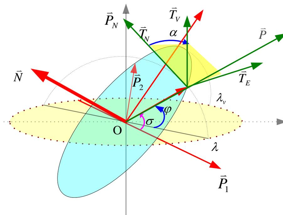
圖 1 大圓法向量及球面上一點切平面上的速度，朝東及朝北切線向量
