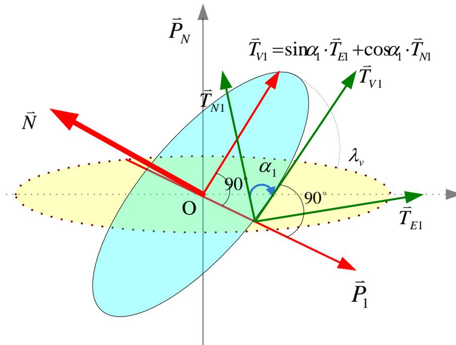
圖 2 已知出發點及航向，大圓上的法向量及速度向量。
